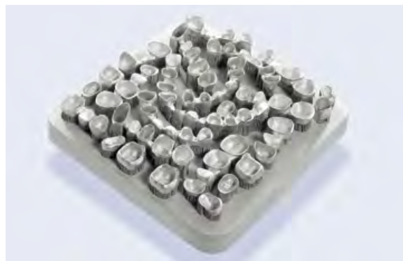
Abb. 3: Auf Bauplattform aufgebaute SLM-Restaurationen mit Supports.
