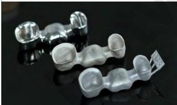
Abb. 1: Dreigliedrige Cobalt-Chrom-Brücke gefräst aus einer Hartmetall-Ronde (l.), gefräst aus einem Sintermetall-Rohling (m.) und additiv hergestellt im Laserschmelzverfahren (r.).
