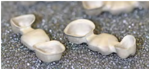
Abb. 6: Gerüste nach dem Dichtsintern unter Argon-Schutzgasflutung.
