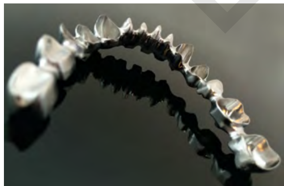
Abb. 7: 14-gliedriges Brückengerüst gefräst aus Hartmetall-Ronde auf CoCr-Basis.
